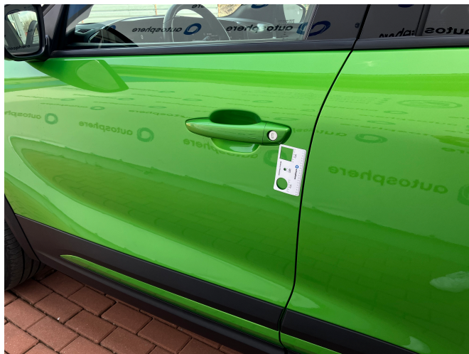
Ľavé predné dvere - poškodený lak na hrane dverí
