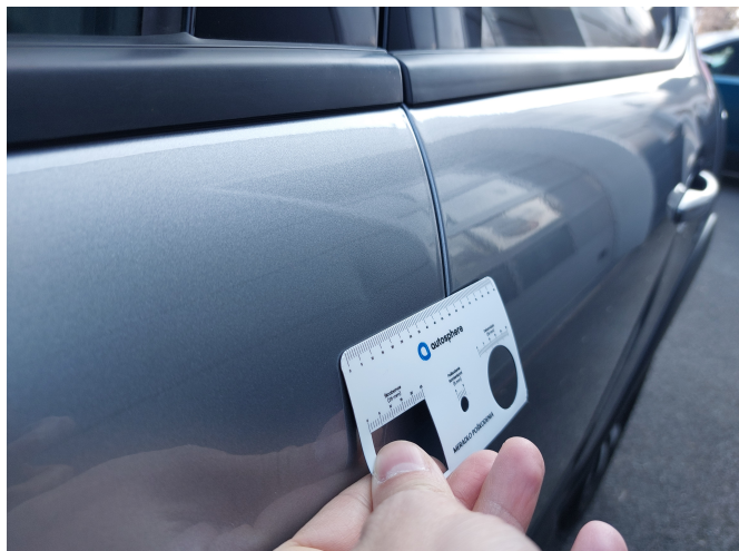
malá preliačina 2 cm na vodičových dverách bez poškodenia laku
