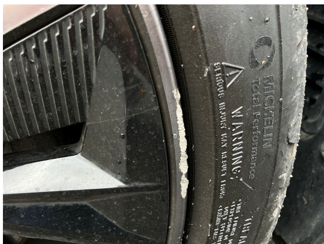
PP disk poškodený
