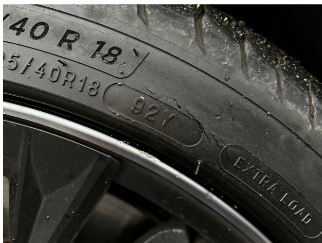
PP pneu poškodená
